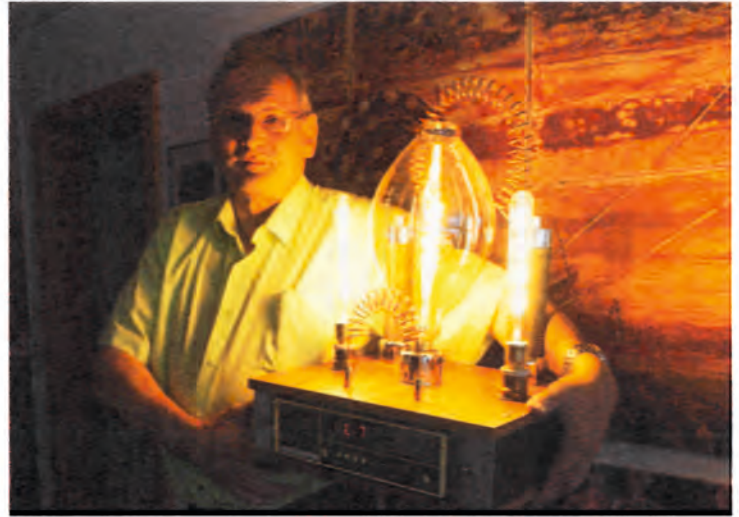
„Röhrenradio“: Hier wurde ein Küchenradio in eine Holzbox eingebaut, in dem drei neue LED-Röhren und zwei alte Messingspulen aufgesetzt wurden.
